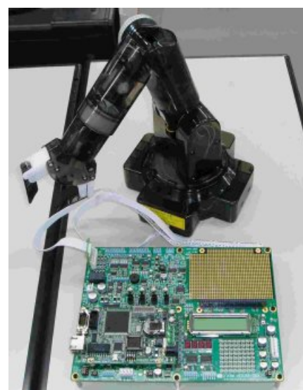
学習キットにロボットアーム (エレキット社製) を接続した図。
